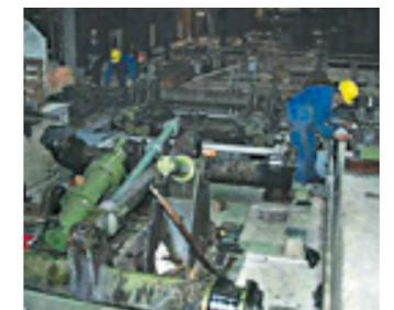
Erweiterung einer Zuführstation für einen Glühofen
