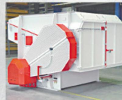
Verkleidung einer Zerkleinerungsmaschine
