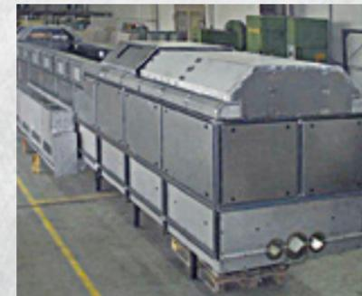
Maschinenverkleidung für eine Walzenerodiermaschine
